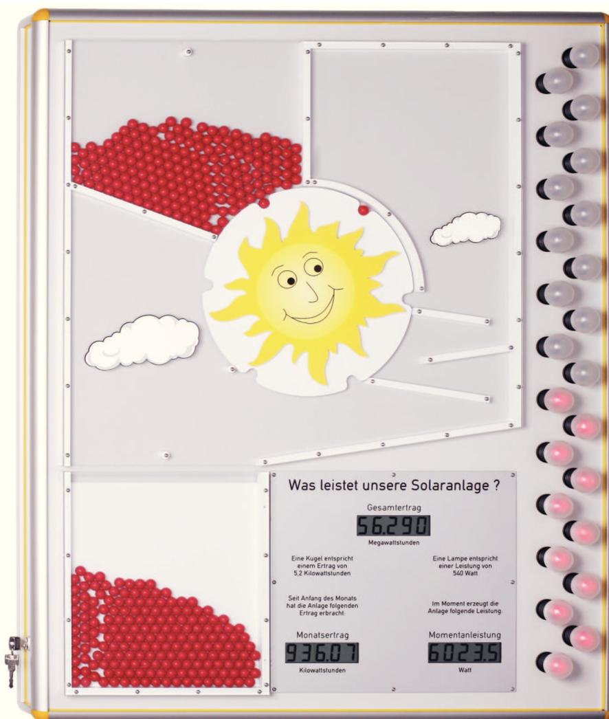
**Die aktuelle elektrische Leistung** wird anschaulich durch eine analoge Anzeige mittels 24 symbolischer Glühlampen (LED) dargestellt. Je größer die aktuelle Anlagenleistung ist, desto mehr Lampen leuchten.
