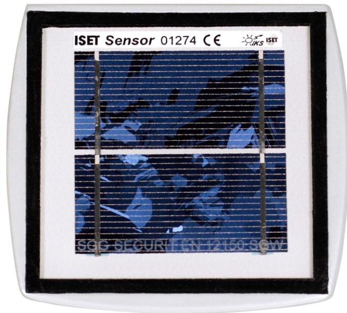
Die Kalibrierung jedes **ISET Sensor** erfolgt in  $W/m^2$  mit einem baugleichen Referenzsensor aus einem akkreditierten Prüflabor und wird auf einem qualitätssichernden Kalibrierschein dokumentiert.
